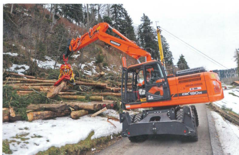
Am Steilhang übernimmt der Doosan DX 190W-3 mit dem Woody 60 die Stämme vom dahinter aufgebauten Seilkran.
